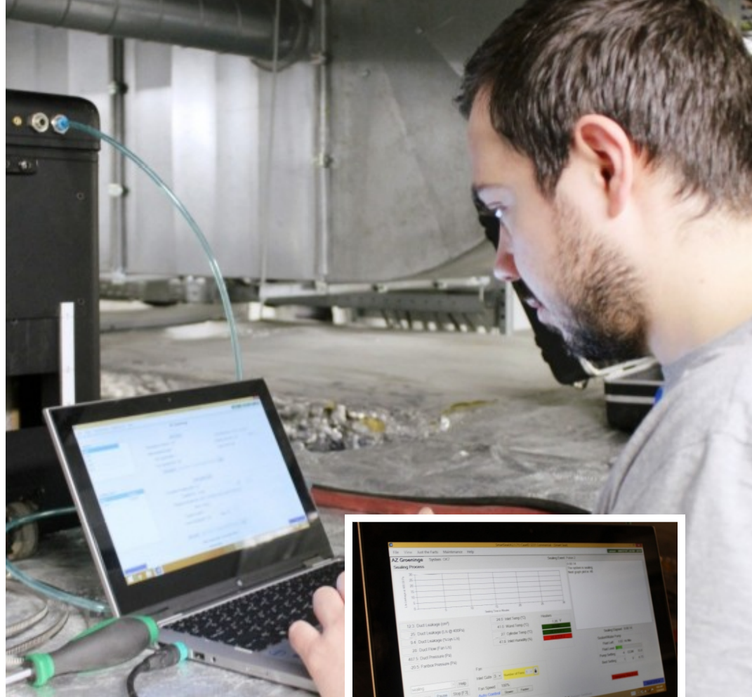
Het sealproces wordt in real time opgevolgd, zodat exact bepaald kan worden welk verliesdebiet overblijft ▲
